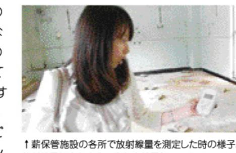
↑薪保管施設の各所で放射線量を測定した時の様子。放射線量は京都市内の大気中線量と同レベル。
